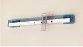
Consente la misura in millimetri del gibbo nella scoliosi della colonna vertebrale. Struttura in plexiglass con due cursori ortogonali fra di loro che consentono spostamento e misura, lunghezza 30 cm. Una bolla di livello controlla l'allineamento orizzontale. Progetto in collaborazione con ricercatori del centro E.P.M. (Ergonomia della Postura e del Movimento) di Milano e sono controllati, per quanto riguarda la precisione, con apparecchiature tarate e munite di certificazione SIT.
